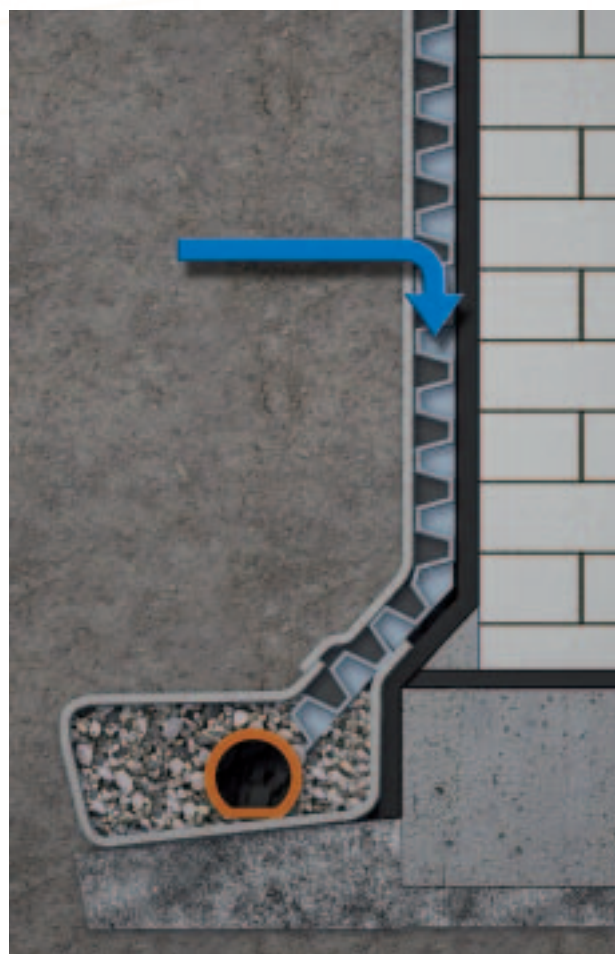
NEPE de protection et drainage.
